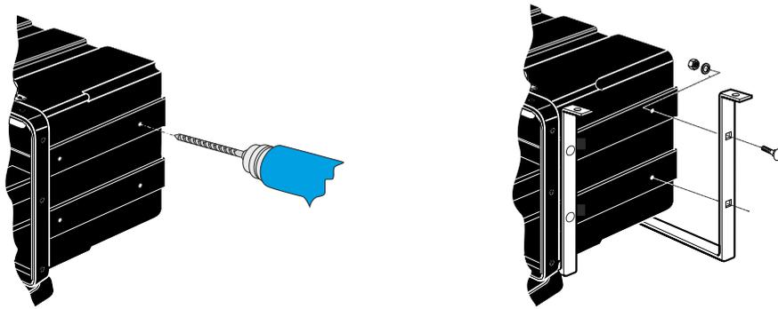
6. Werkzeugkasten mit **geeignetem** Befestigungsmaterial sicher am Fahrzeug anschrauben.
